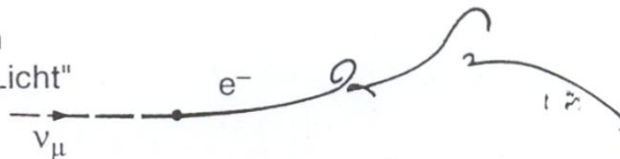
Abb. 9. Dieses erste Ereignis mit einem neutralen schwachen Strom wurde in Aachen entdeckt. Ein Neutrino dringt von links in die Blaskammer ein (auf dem Bild nicht sichtbar) und wird elastisch an einem Elektron gestreut. Das Elektron ist als rechte Spurkaskade (Bremsstrahlung) zu erkennen. Dieses Bild ist in die Geschichte des CERN eingegangen
