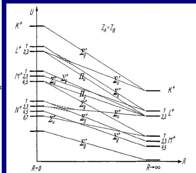
"Korrelations Diagramm": MO Niveauschema für innere Elektronen-Schalen
