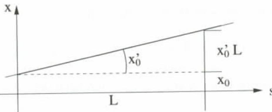
Abb. 4.8. Illustration zur Wirkung einer Driftstrecke
