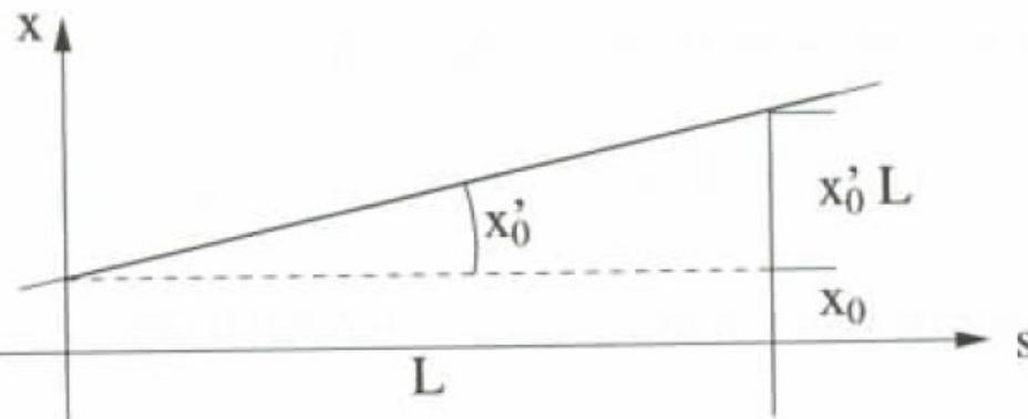
Abb. 4.8. Illustration zur Wirkung einer Driftstrecke
