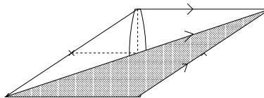
Wenn wir eine Hälfte der Linse abdecken, geht Licht verloren, in der Zeichnung der schraffierte Teil des Lichtbündels, aber der Gegenstand wird auf denselben Punkt abgebildet wie bei unbedeckter Linse.
