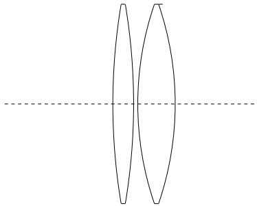
Lösung: Die Strahlen vom linken Brennpunkt der linken Linse sind zwischen den Linsen parallel, die rechte Linse fokussiert sie in ihrem rechten Brennpunkt. Also Gegenstandsweite  $g = f_1$ , Bildweite  $b = f_2 > 0$ ,  $\Rightarrow$  Brennweite des Systems ist  $1/r = 1/g + 1/b = 1/f_1 + 1/f_2 \Rightarrow f = 143 \text{ mm}$ .
