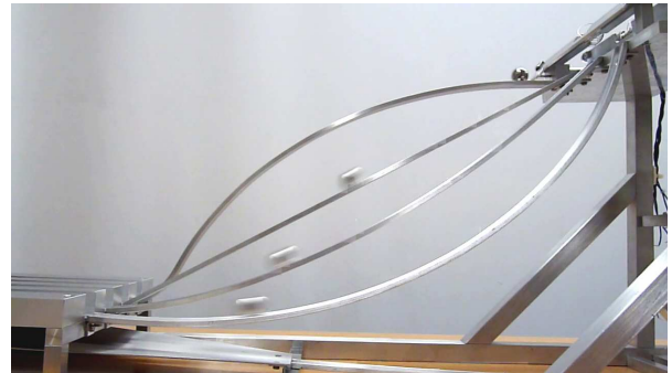
Abb. 6. Exponat „Rollbahnen/Brachistochrone“. Das Foto zeigt die verschiedenen Positionen der vier Kugeln, die alle gleichzeitig gestartet wurden. Die Kugel auf der Bahn im Vordergrund erreicht das Ziel als erste („Brachistochrone“). Die Kugel auf der kürzesten Bahn (Bahn 3) ist langsamer.
