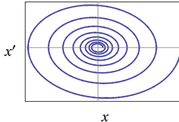
Die Amplituden der Schwingung fallen bei nicht zu starker Dämpfung exponentiell ab. Die Energie in der Schwingung wird durch Reibungsarbeit verbraucht.
