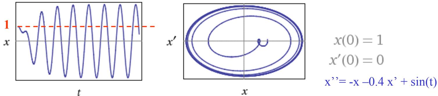
**Bei der erzwungenen Schwingung wird die Amplitude nach einiger Zeit konstant. Dann ist die Leistung der Reibungskraft genau so gross wie die Arbeit der äusseren Kraft.**
