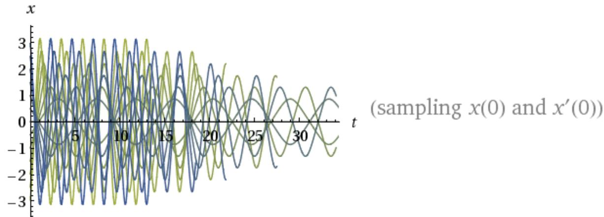
*Abb.: Nichtlineare Schwingungen für eine rücktreibende Kraft  $F = -k \cdot x^3$  und verschiedene Amplituden. Die Frequenz hängt stark von der Amplitude ab.*
