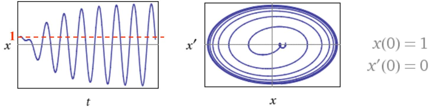
Abb.: Erzwungene Schwingung eines gedämpften Systems. Die Schwingung schaukelt sich auf (Einschwingvorgang) und erreicht dann eine konstante Amplitude bei der Frequenz der äußeren Kraft. Wird die Dämpfung verdoppelt, dann halbiert sich die Endamplitude.
