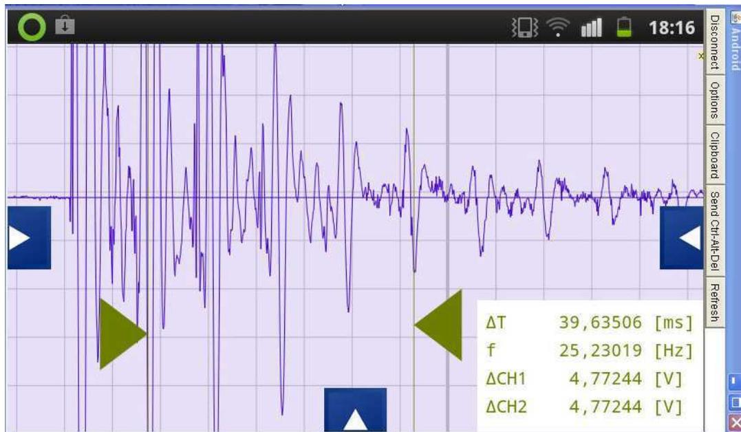
*Abb.: Ergebnis einer Messung Mit dem Smartphone. Man sieht 9 Reflektionen, die jeweils einem Schallweg von 3.2 m entsprechen.*
