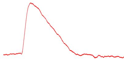
Abbildung 6.7: Zeitlicher Verlauf des AmpOut Pulses
