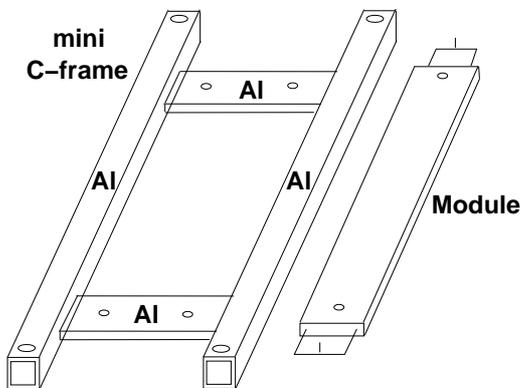
**Figure 5:** Schematic view of the mini C-frame.
