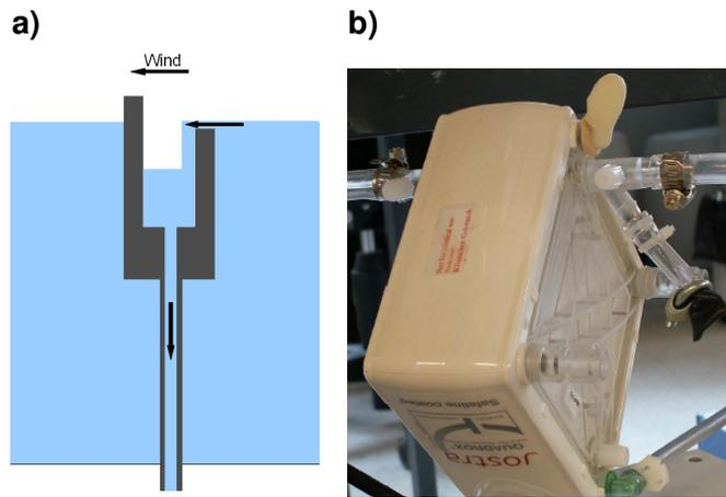
Abbildung 12: **a)** Mit dem *Skimmer* können Oberflächenfilme von der Wasseroberfläche abgesaugt werden. **b)** Der *Oxygenator* dient zur Begasung des Wassers.
