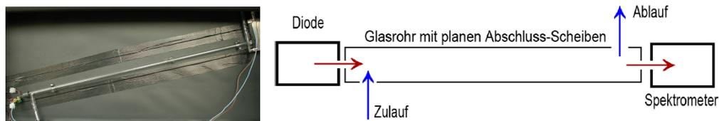
Abbildung 14: Das Absorptionsspektrometer.
