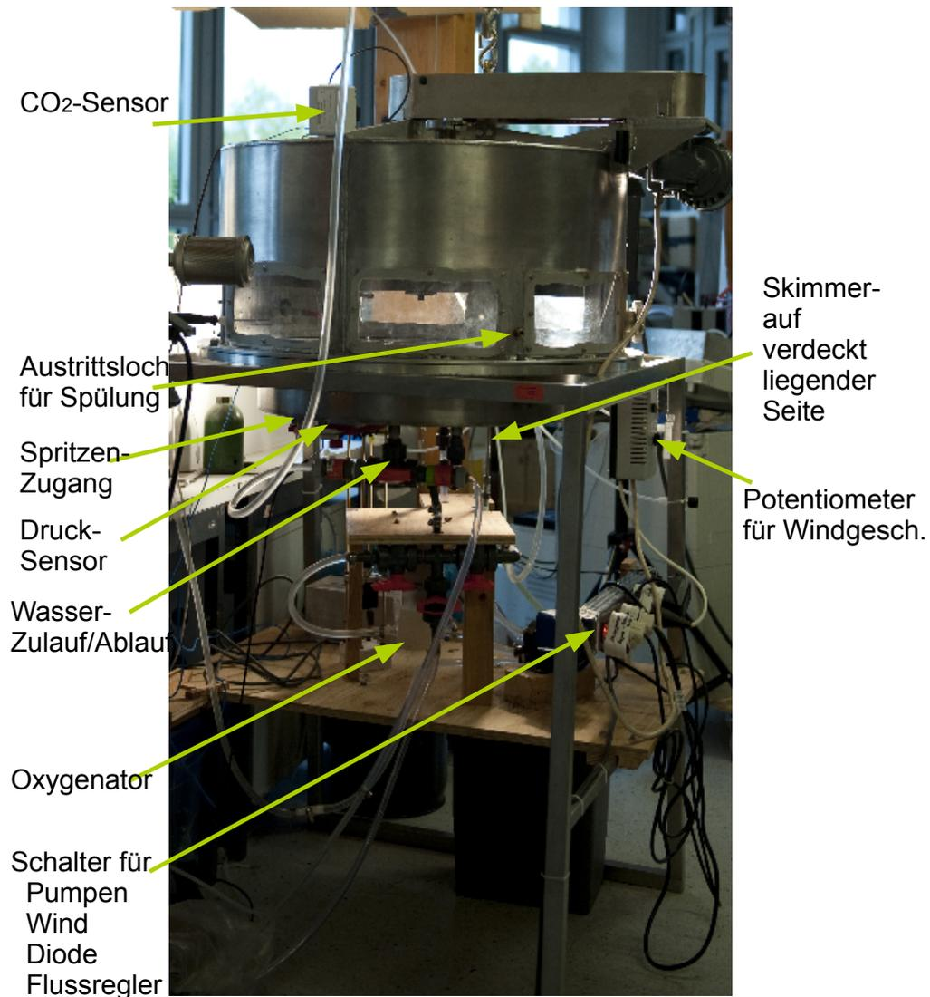
Abbildung 10: Anordnung einiger Bestandteile des Versuchsaufbaus.
