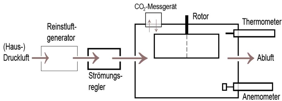
Abbildung 11: Luftraum des Wind-Wellen-Kanals.
