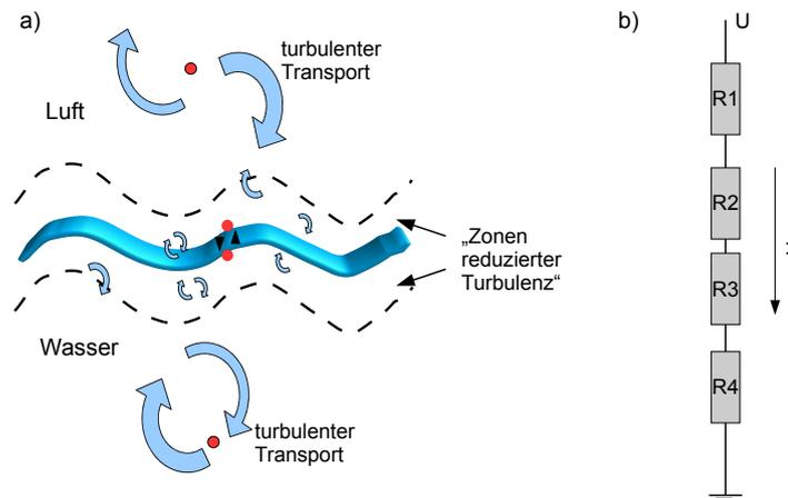
Abbildung 2: **a)** Aufteilung der Luft-Wasser Grenzfläche in verschiedene Zonen. Fernab der Wasseroberfläche dominiert der turbulente Transport. Nahe der Oberfläche existieren Grenzschichten mit reduzierter Turbulenz, in denen molekulare Diffusion gegenüber turbulentem Transport überwiegt. **b)** Analogie zu einer Reihenschaltung von Widerständen, siehe Text.
