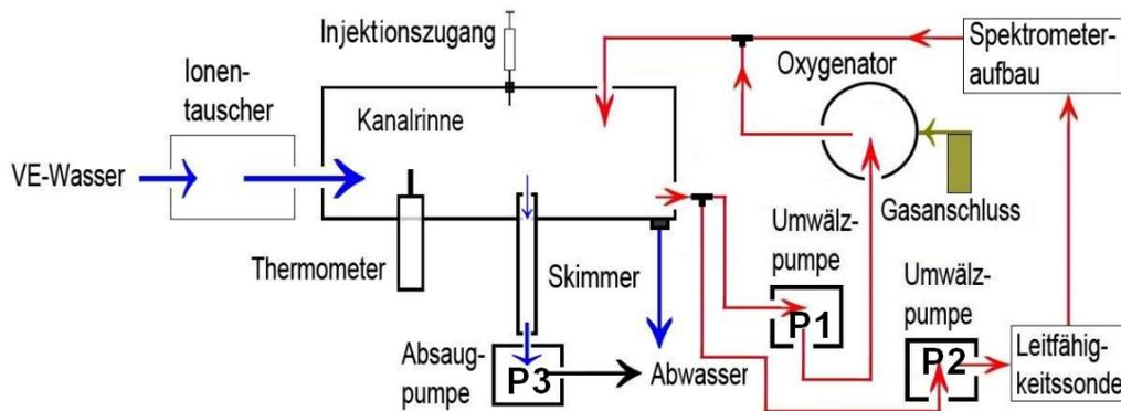
Abbildung 13: Wasserkreisläufe (blau = Kanal, rot = Bypass).
