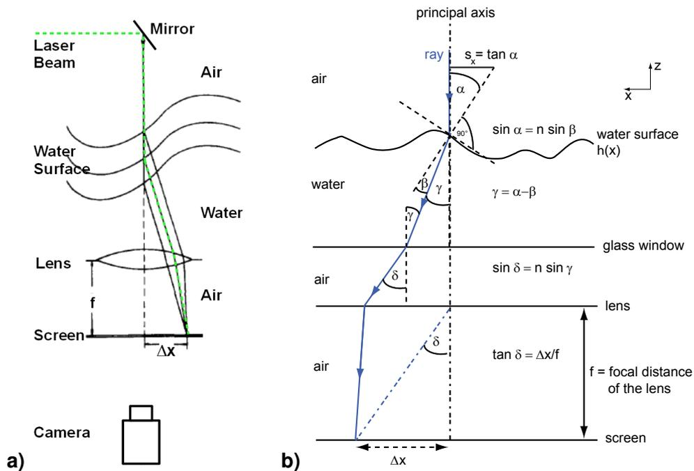
Abbildung 15: **a)** Aufbau der Laser Slope Gauge (LSG) zur Vermessung der Wellenneigung (Skizze modifiziert nach Dutzi [3]). **b)** Strahlengang und Prinzip der LSG. Die Oberflächenneigung  $s_x = \tan \alpha = \frac{\partial h}{\partial x}$  ist durch die Brennweite der Linse  $f$  und den Brechungsindex  $n$  von Wasser eindeutig mit der Strahlablenkung  $\Delta x$  auf dem Schirm verknüpft.
