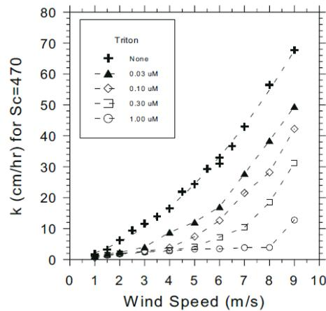
Abbildung 6: Beispiel für den Einfluss von Oberflächenfilmen auf den Gasaustausch. Quelle: Frew et al. [4]
