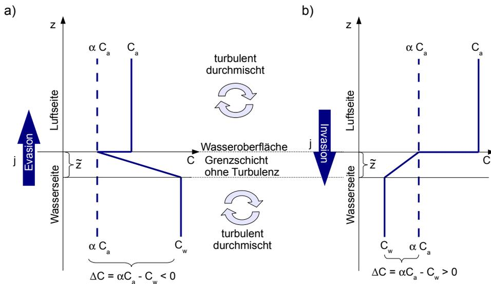
Abbildung 3: Konzentrationsverlauf im *Filmmodell* für Evasion (**a**) und Invasion (**b**). Die Löslichkeit ist in beiden Fällen  $\alpha = 0,5$ .
