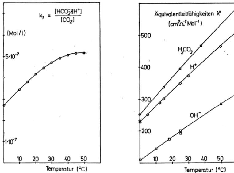
Abbildung 7: links: Temperaturabhängigkeit der Dissoziationskonstante  $K_1$  nach für die Reaktion in Gleichung (17). rechts: Temperaturabhängigkeit der Äquivalentleitfähigkeiten. Quelle: Jähne [6, 1980]
