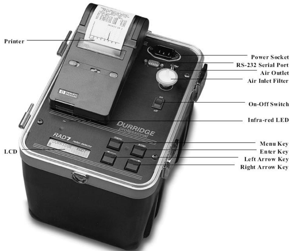
Abbildung 3.8: Das Gerät RAD7 aus DurrIDGE [2001]
