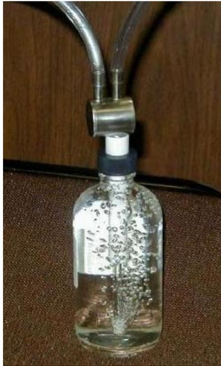
Abbildung 5.6: Entgasung des Grundwassers mit Hilfe der Glasfritte, aus DurrIDGE [2001]
