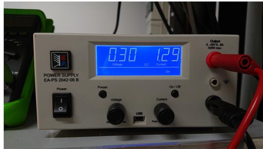
Abbildung 3.4: Netzgerät und Widerstandsmessung zur Zellenkühlung
