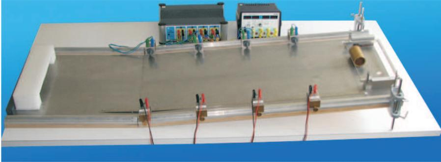
Abbildung 1: Aufbau des Versuchs schiefe Ebene.
