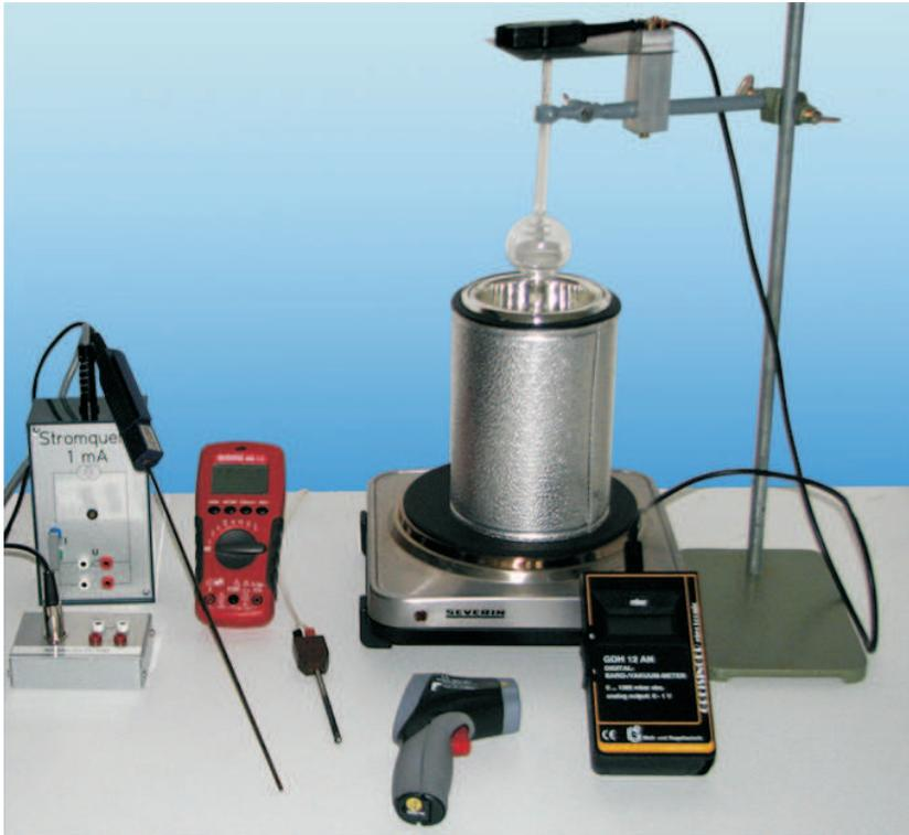
Abbildung 1: *Aufbau des Versuchs Temperaturmessung.*
