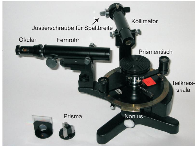
Abbildung 1: Aufbau des Prismenspektrometers Versuchs.
