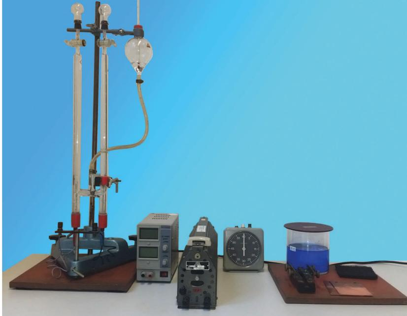
Abbildung 1: Übersicht des Versuchs Elektrolyse.
