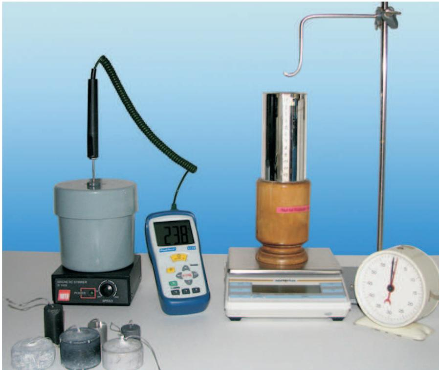
Abbildung 1: Aufbau des Versuchs spezifische Wärmekapazität fester Körper.
