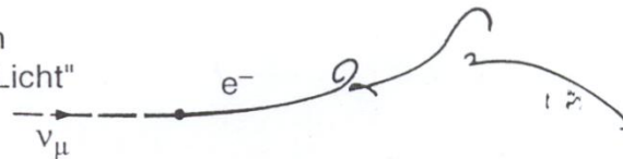
Abb. 9. Dieses erste Ereignis mit einem neutralen schwachen Strom wurde in Aachen entdeckt. Ein Neutrino dringt von links in die Blasenkammer ein (auf dem Bild nicht sichtbar) und wird elastisch an einem Elektron gestreut. Das Elektron ist als rechte Spurkaskade (Bremsstrahlung) zu erkennen. Dieses Bild ist in die Geschichte des CERN eingegangen
