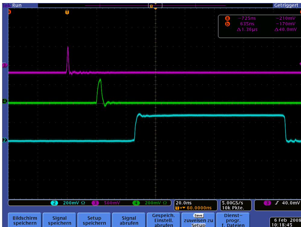
Bild 16: Violett: Analog-Input; Grün: Discr.-Ausgang; Blau: Stretcher-Ausgang Schwelle: -100mV; Hysterese: 30mV;
