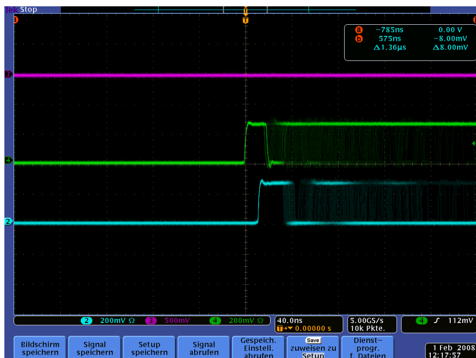
Bild 14: Schwelle: 0 mV; Hysterese: 10mV
