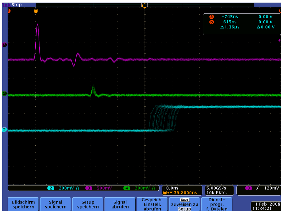
Bild 7: Schwelle: +490 mV; Hysterese: 0mV
