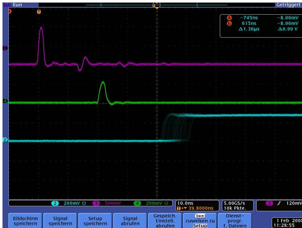
Bild 5: Schwelle: 0mV; Hysterese: 30mV
