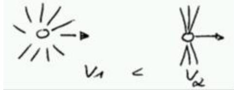
Durch Lorentzkontraktion nimmt die transversale E-Feld Komponente der bewegten Ladung zu, d.h. das Medium sieht effektiv eine höhere Ladung. Der relativistische Anstieg ist aber ein sehr kleiner Effekt. In 1. Näherung können Teilchen mit  $\beta\gamma > 3$  als MIP (minimal ionising particle) betrachtet werden.
