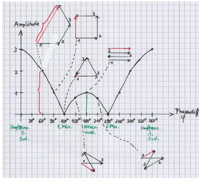
Abb. 4: Amplitude des resultierenden Pfeils, nach [DornBader].
