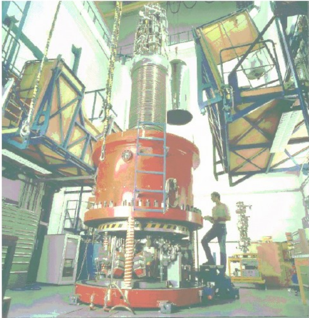
10 MV Van de Graaff accelerator (HMI)
