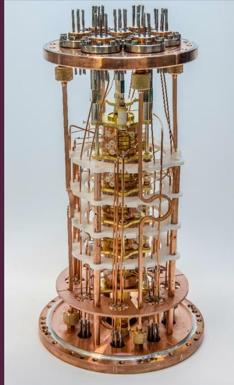
Abbildung: Der PENTATRAP Penning-Fallen-Turm für Präzisionsmassenmessungen an hochgeladenen Ionen (Foto: Ralf Lackner, MPIK)
