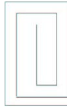
Abbildung 4.24: Prinzipieller Aufbau einer Fresnelspule, die in x^2 bzw. y^2 korrigiert.
