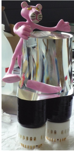
(a) Lichtleiter mit zwei Photomultipliern und Labormaskottchen
