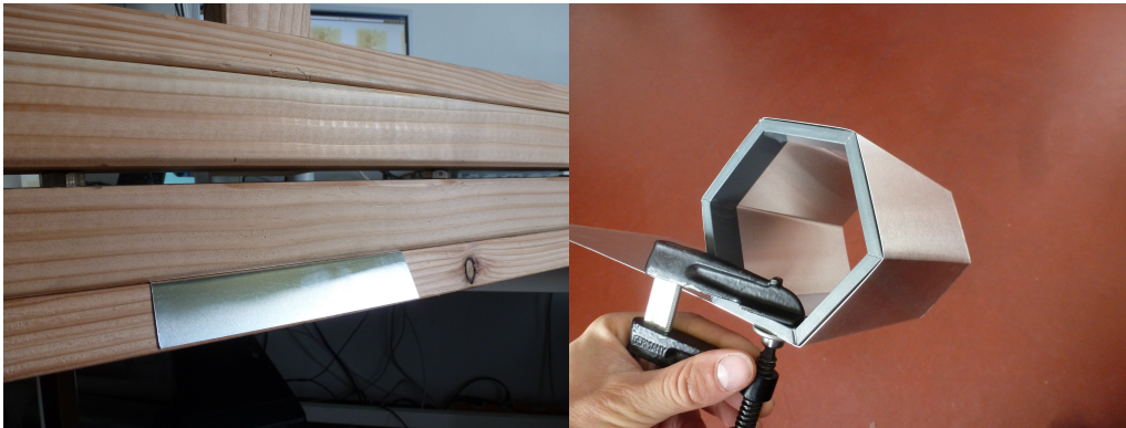
Abbildung B.2: Selbstgebaute Biegebank. Links: Das Aluminium-Blech wird zwischen zwei Bretter eingespannt. Die oberen beiden Bretter können über Schaniere gegen das Blech gedrückt werden und dieses somit auf einen Winkel von 120 Grad biegen. Rechts: Man sieht einen leichten Radius an der Biegefalz. Das Aluminiumblech wölbt sich dadurch leicht. Das kann verhindert werden, indem die Ecken des Hexagons abgerundet werden.
