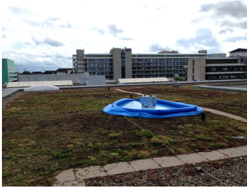
Abbildung 5.7: Nachweisstudie der Funktion der Bodenfeuchtemessung des neuen Detektionssystem. Links: Das Dach des Physikalischen Instituts der Universität Heidelberg auf dem ein Wasserbecken mit 5 m Durchmesser platziert ist. In dessen Mitte und ca. 20 cm über dem Wasserspiegel sind das Hydroinnova und das ^{10}\text{B} -basierte Detektionssystem in einer Aluminiumbox untergebracht. Rechts: Skizze des Physikalischen Instituts mit den beiden Dachzugängen sowie dem Wasserbecken in blau und dem Boden samt Bepflanzung in grün. Der Grundriss des Instituts hat die Maße 60,1x53,1m
