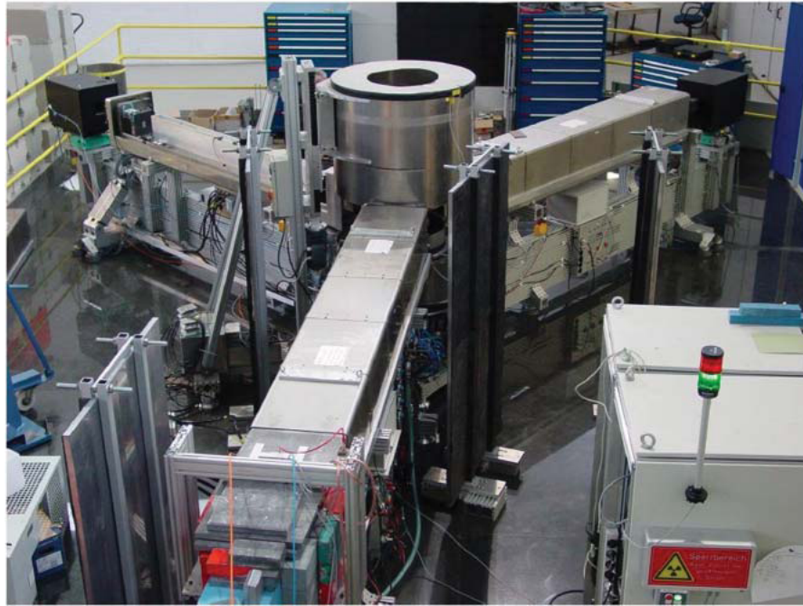
Abbildung 5.1: Der Strahlplatz RESEDA am FRM II. Zu sehen ist im Vordergrund der primäre Spektrometerarm und die Probenposition. Im Hintergrund die beiden sekundären Spektrometerarme mit den Detektoren in den schwarzen Abschirmungskästen.
