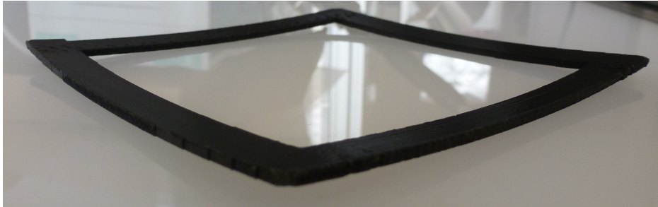
Abbildung 3.4: ABS-Prototyp eines auf eine Kugelfläche gezogenen Rahmens.
