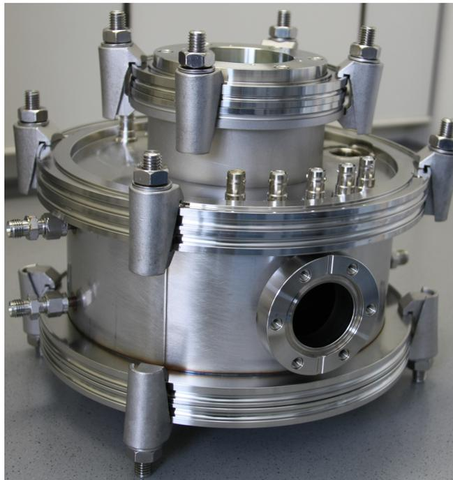
Abbildung 107: Kammer nach dem Reinigen
