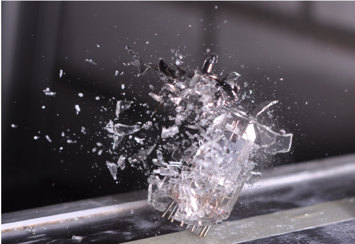
Abbildung 2.1: Ein implodierendes Vakuumrohr. Abbildung unverändert übernommen aus [13].
