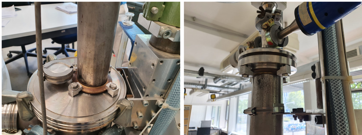
Abbildung 5.2: Links: Der untere Rohrflansch auf dem Deckel der Vakuumkammer. Rechts: Die Rohrschelle (unten) und der oberer Flansch (oben).
