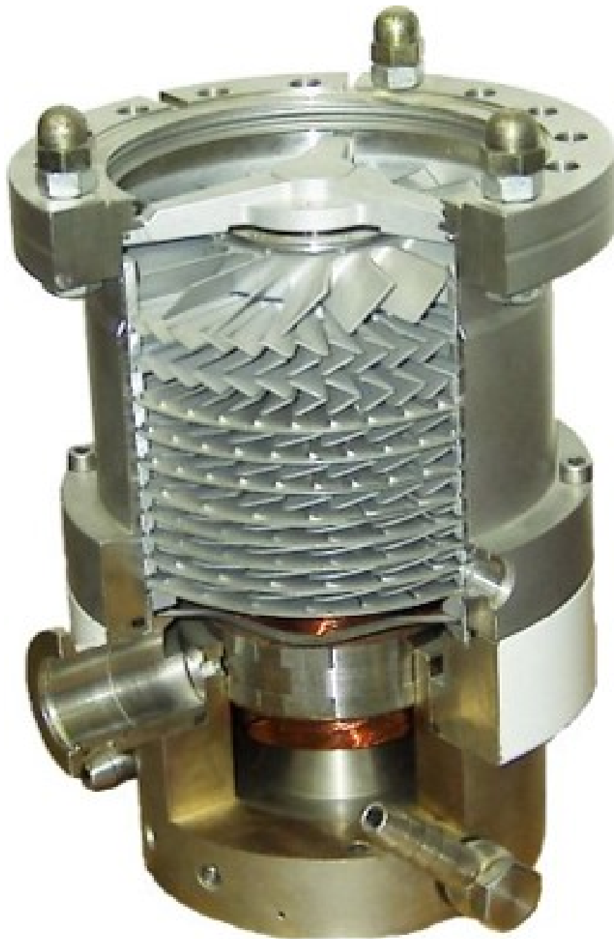
Abbildung 2.5: Eine geöffnete 10-stufige TMP. Am oberen Ende befindet sich die Saugseite mit einem Hochvakuumflansch und dem Magnetlager, unten lässt sich der Elektromotor erkennen. Abbildung unverändert übernommen aus [15].
