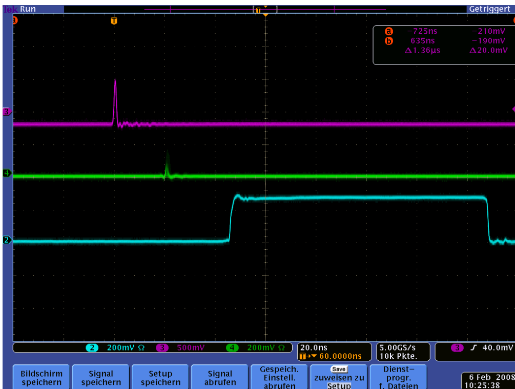
Violett: Analog-Input; Grün: Discr.-Ausgang; Blau: Stretcher-Ausgang Schwelle: -3mV; Hysterese: 30mV;
