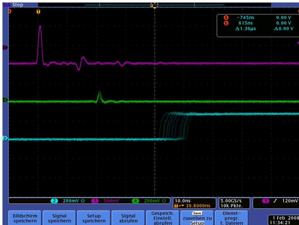
Bild 7: Schwelle: +490 mV; Hysterese: 0mV
