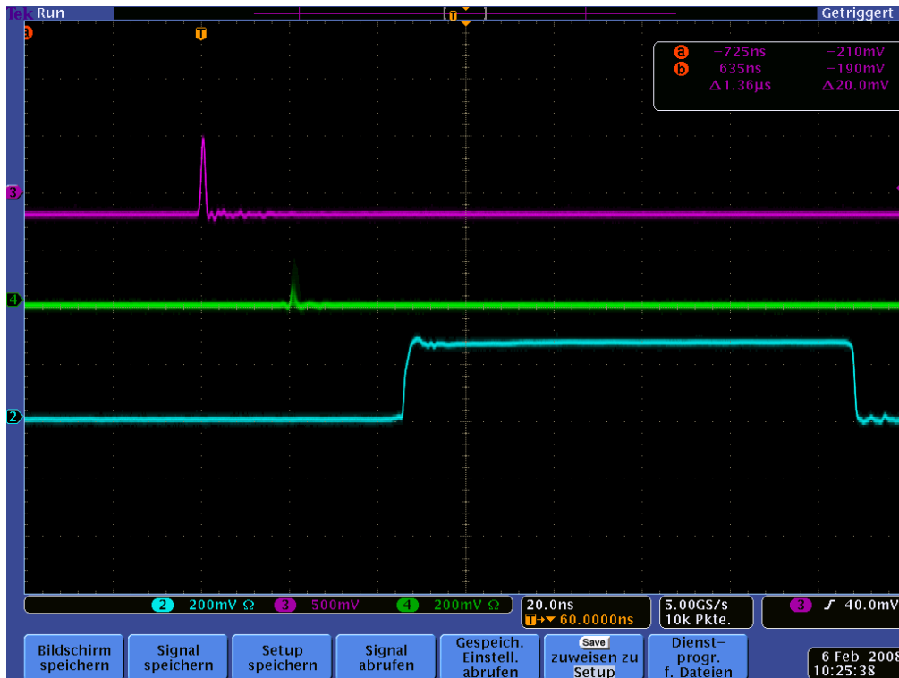
Bild 17: Violett: Analog-Input; Grün: Discr.-Ausgang; Blau: Stretcher-Ausgang Schwelle: -3mV; Hysterese: 30mV;
