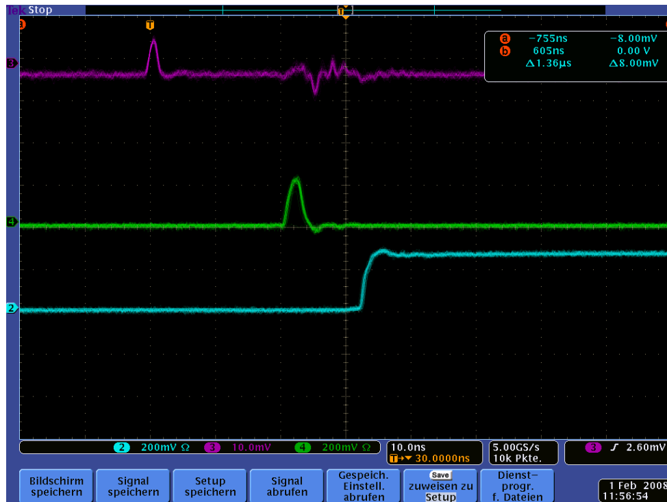
Bild 9: Schwelle: 0 mV; Hysterese: 0mV
