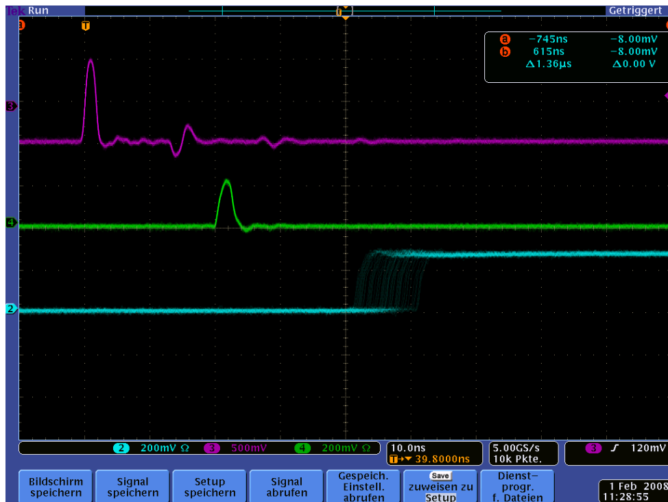
Bild 5: Schwelle: 0mV; Hysterese: 30mV
