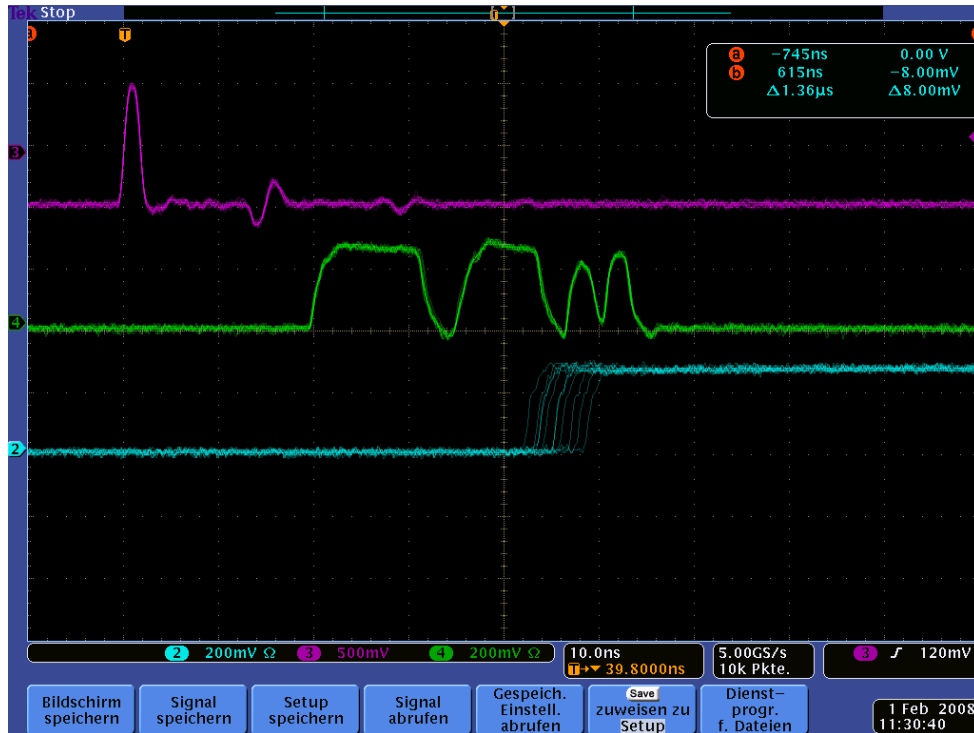
Bild 6: Schwelle: -490 mV; Hysterese: 0mV
