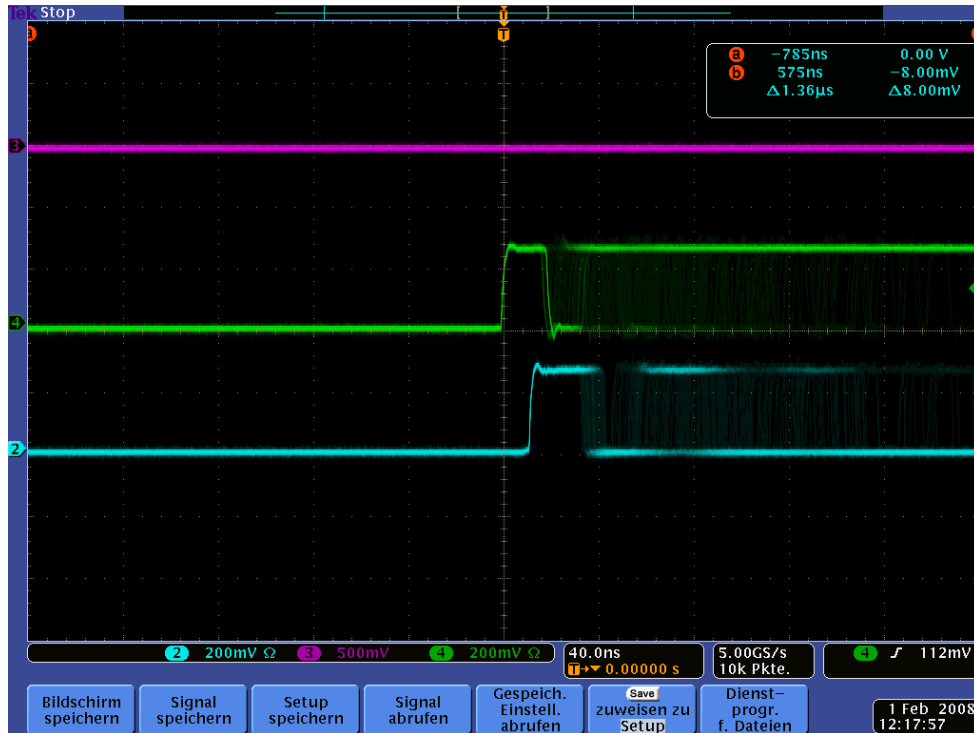
Bild 14: Schwelle: 0 mV; Hysterese: 10mV
