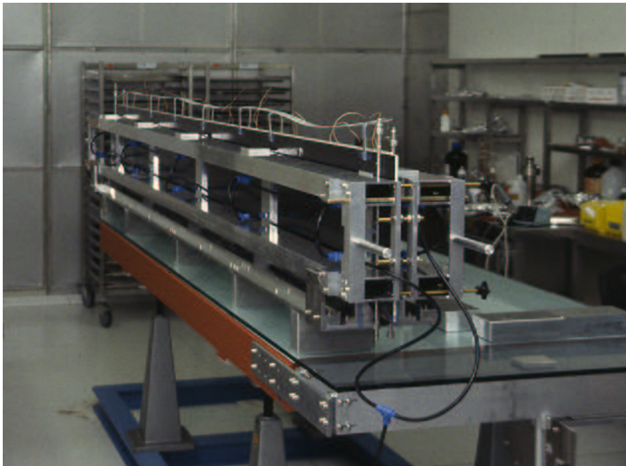
Abbildung 2.10: Das Modul mit kompletter Tragevorrichtung in seitlicher Lage. Die Seitenwand des Moduls ist noch nicht aufgeklebt. Die Kupferlitzen von den Modullagen sind durch die Löcher in der Seitenwand bereits durchgefädelt.
