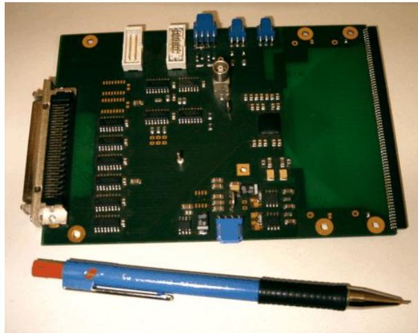
Abbildung 3.3: Testkarte AS20 für den CIPix-Chip.
