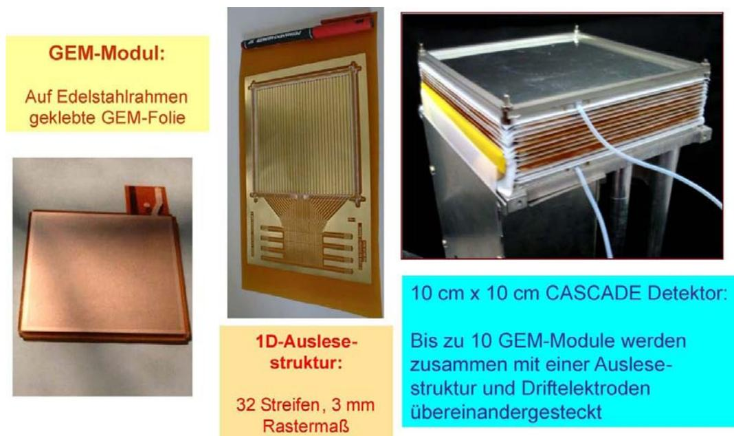
Abbildung 2.5: Modulares Konzept des CASCADE Neutronendetektors: die GEM-Folien, die Driftelektroden und die Auslesestruktur werden auf Edelstahlrahmen geklebt. Übereinandergesteckt, bilden diese Module einen Detektorstapel wie er beispielhaft im rechten Teilbild zu sehen ist.
