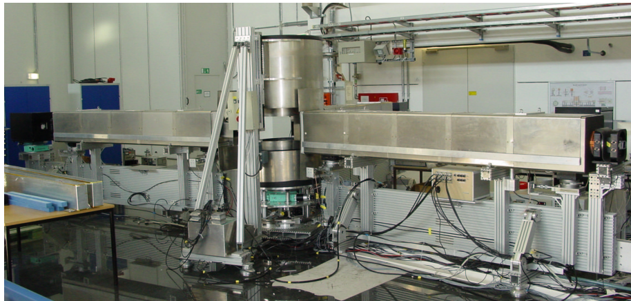
Abbildung 8.2: Das Spektrometer RESEDA. Die Neutronen fallen von rechts ein, am linken Rand befindet sich der Detektor (Das Bild wurde von W. Häußler, FRM II, zur Verfügung gestellt).
