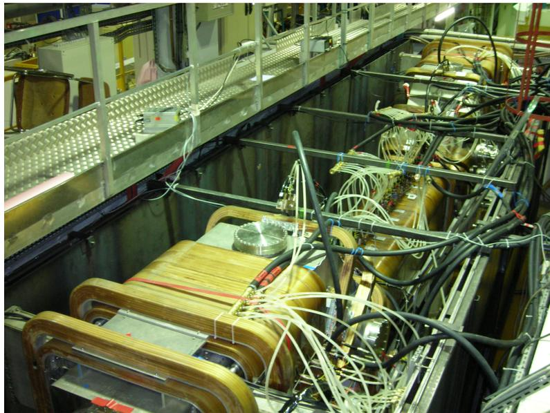
Abbildung 3.5: PERKEO III mit Strom- und Wasseranschlüssen.
