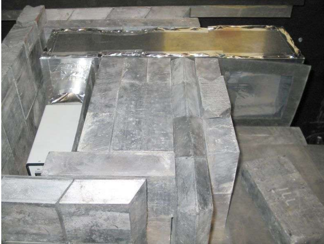
Abbildung 5.7: Bleiabschirmung der Kamera. Gegenüber dem Objekt ist die Kamera mit 20 cm Blei abgeschirmt. Die Bleiabschirmung gegen die \gamma -Strahlung des Beamstops ist 10 cm dick. Um die Abschirmung und den Kamerakasten gegen eine Aktivierung durch Neutronen zu schützen, wird der Aufbau noch mit B_4C abgedeckt.
