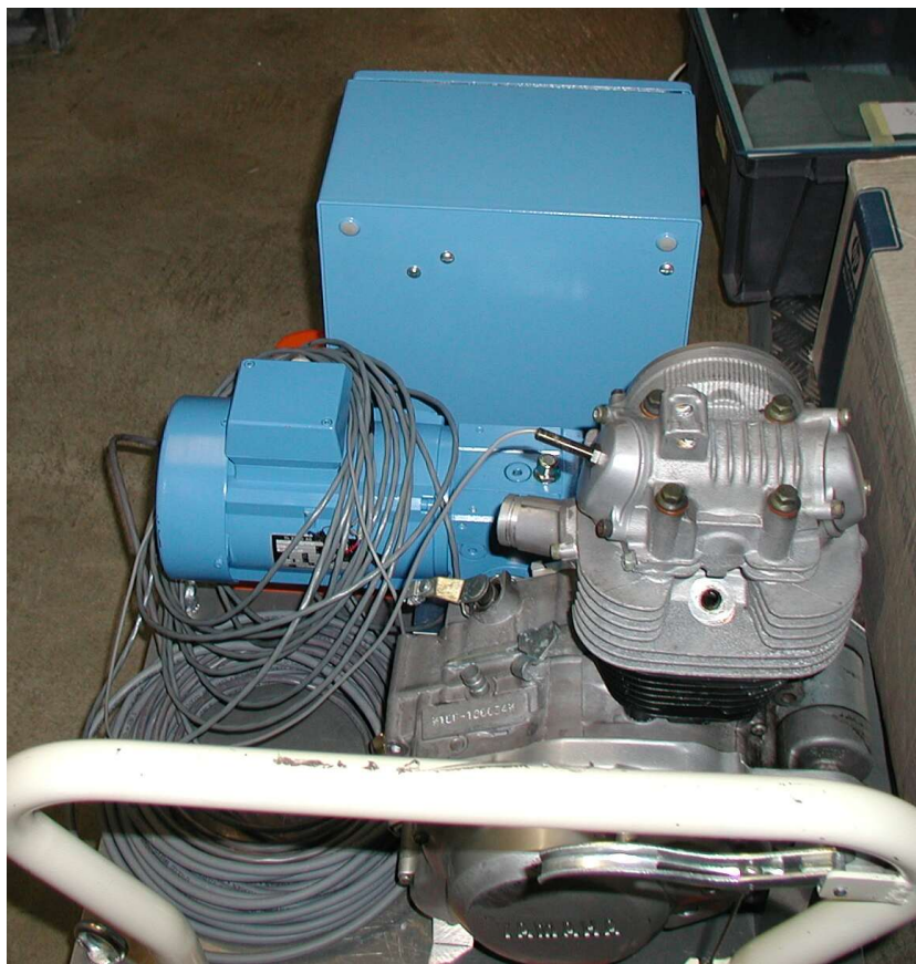
Abbildung 6.6: Motorteststand. Im Hintergrund ist der Elektromotor mit Steuerungskasten zu sehen. Der Stecker am oberen Teil des Motorradmotors ist die Verbindung zum eingebauten Trigger.
