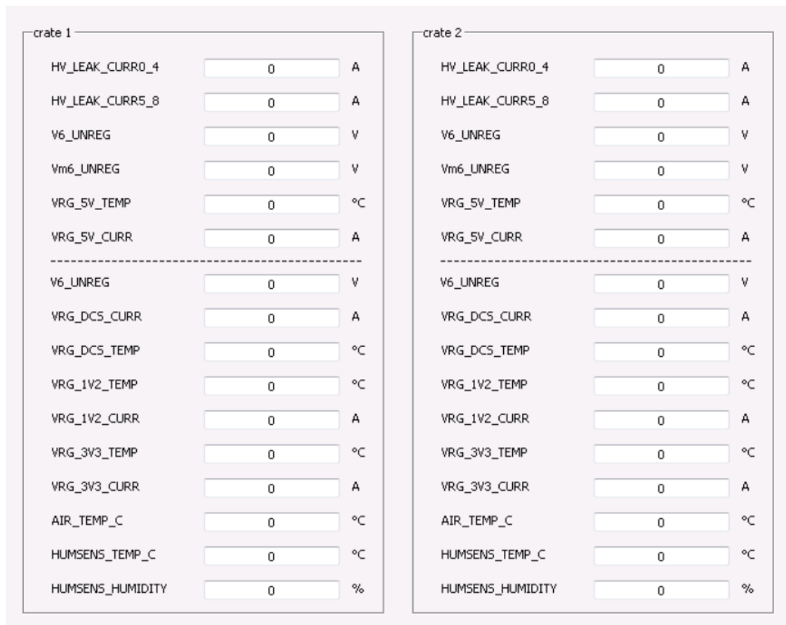
Abbildung 16: Die Zustände der beiden Boxen 1 und 2 sind in zwei Bereichen dargestellt. Im oberen Bereich sind Leckströme, Spannungen im unregulierten Gleichrichter, Temperatur und Strom eines Spannungsreglers auf der Backplane dargestellt. Im unteren Bereich ist die Spannung im unregulierten Gleichrichter, Temperatur und Spannungen dreier Spannungsregler, Lufttemperatur und Luftfeuchtigkeit auf der Kontrollerkarte dargestellt. Als das Bild erstellt wurde, sind keine Daten gemessen worden.
