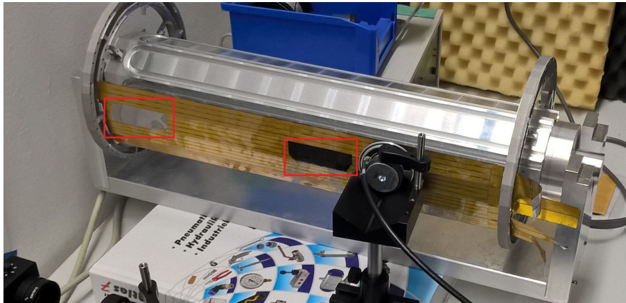
Abbildung 6: Detektormodulprototyp der dritten Lage. Die bedampften Glasplatten wurden zentral und am Rand eingebaut (rot markiert). Die Gaszufuhr erfolgt über die Endringe. Hinter dem Modul befindet sich ein Ausschnitt eines Modells des Strahlrohrs.
